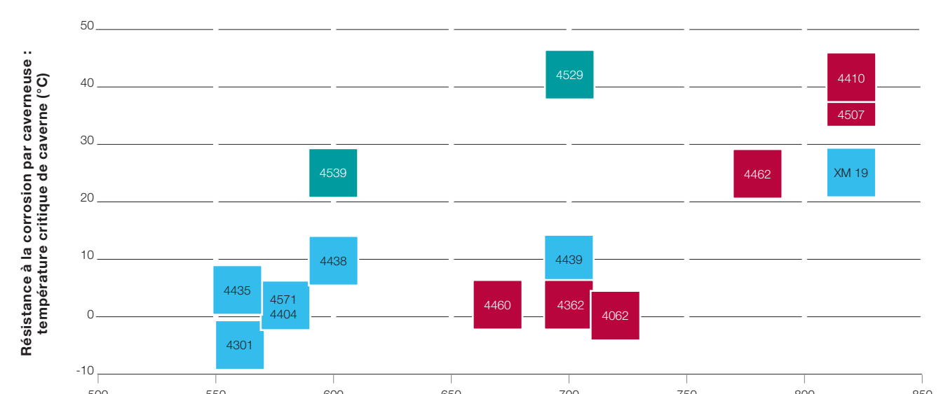
Caractéristiques mécaniques : Rm (MPa) Corrosion caverneuse - Test de type ASTM G48 en milieu chlorure ferrique - valeurs indicatives
